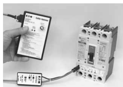
Digitrip 310+ JG MCCBに取り付けたテストキット
